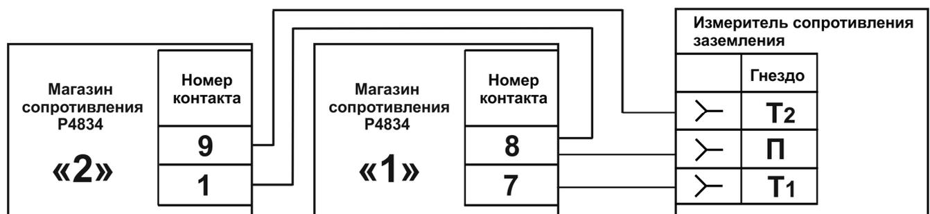
Рисунок 6.6.2 – Схема подключения при опробовании !
