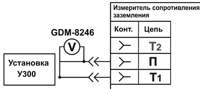
Рисунок 6.7.1 – Схемы определения погрешности измерений напряжения переменного тока
