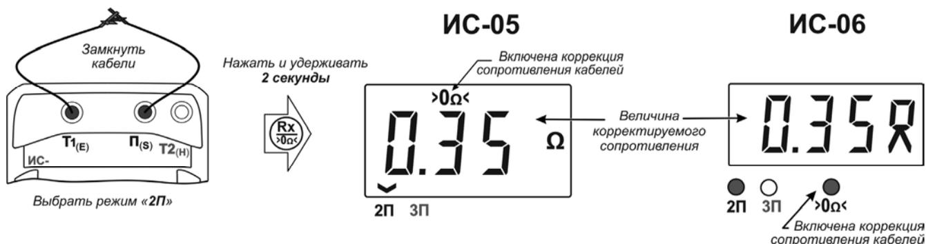
Рисунок 4 – Коррекция сопротивления измерительных кабелей (2П)
