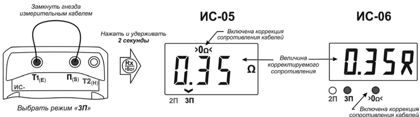
Рисунок 3 – Коррекция сопротивления измерительного кабеля (3П)
