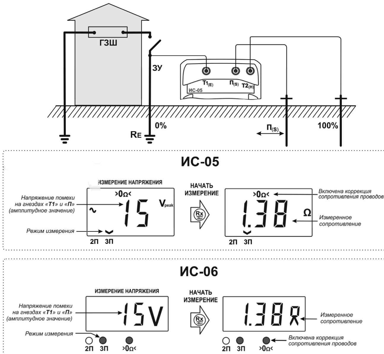
Рисунок 5 - Схема подключения и вид индикатора при измерении сопротивления заземления трёхпроводным методом
