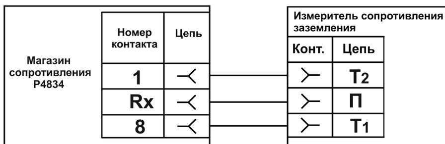
Номер контакта магазина сопротивлений при подключения гнезда « П » прибора в зависимости от измеряемого сопротивления: Rx – 7 для R от 0,1 до 0,9 Ом; Rx – 6 для R от 1 до 9 Ом; Rx – 5 для R от 10 до 90 Ом; Rx – 3 для R от 0,1 до 9 кОм
