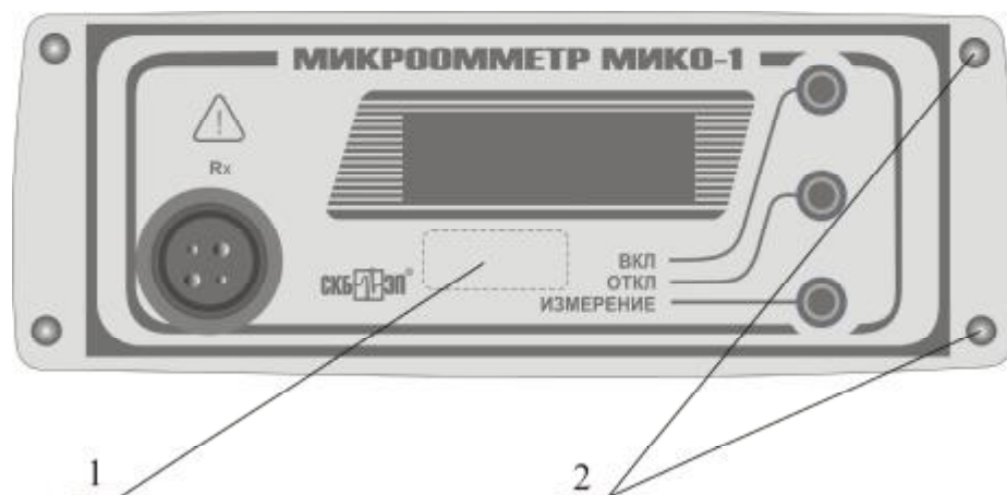
Рис. 2. Схема передней панели измерительного блока 1. Место для нанесения оттисков клейм или размещения наклеек 2. Места нанесения пломб
